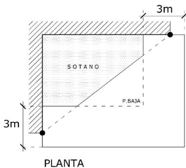
El sótano deberá estar totalmente enterrado o semienterrado salvo en el acceso peatonal y rodado. El frente de fachada para el acceso a la planta sótano de aparcamientos deberá ser como máximo de 5 metros (7 metros para locales donde se requiera doble sentido de circulación), debiendo quedar el resto enterrada (como máximo a 1,20 m. del terreno modificado).
