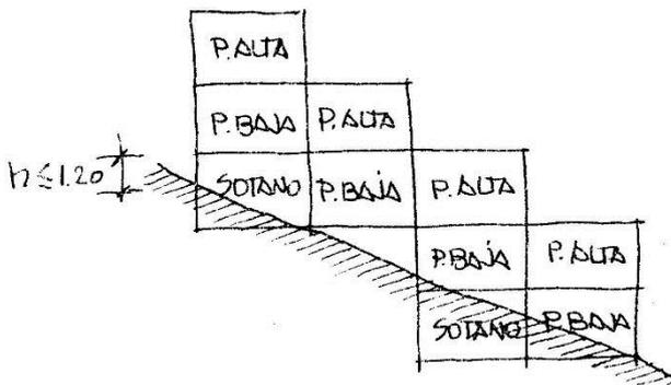
Si la cara superior del forjado que cubre a la posible planta sótano tiene cota  $\geq 1,20$  respecto del terreno, o de los planos de rasante, dicha planta tendrá la consideración de planta baja y por tanto contabilizará en todos los casos a efectos de edificabilidad.
