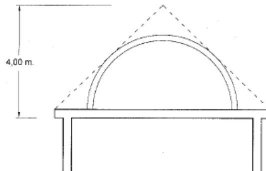
2º No se podrá construir ningún tipo de volumen que sobresalga del plano de cubierta salvo los de chimeneas o shunts.
